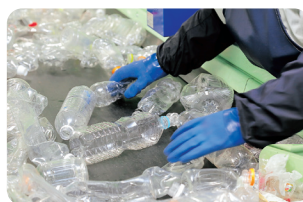
ペットボトル (左) とプラスチック容器包装 (下) の選別の様子。
